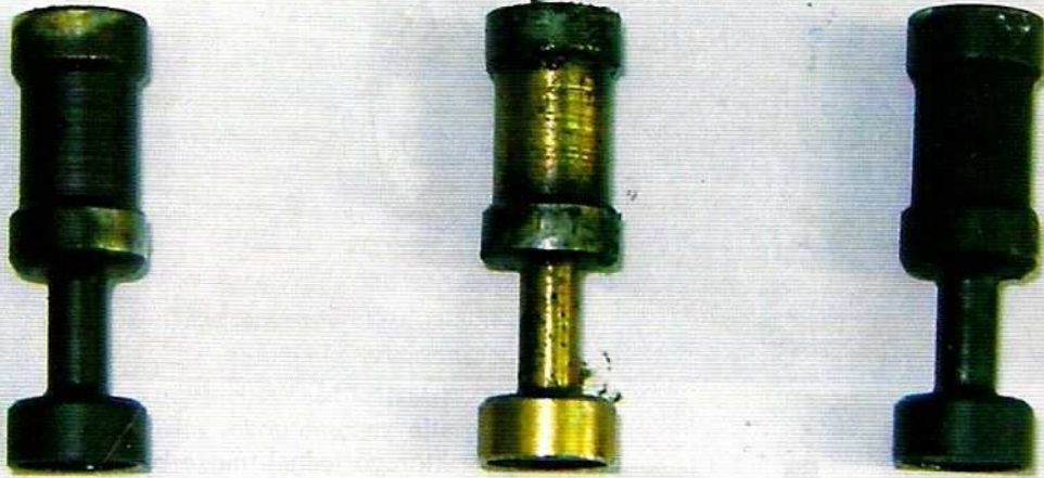
Uszkodzenie elementów wykonawczych na skutek zanieczyszczeń.
