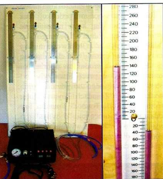
Stanowisko do kontroli wtryskiwaczy gazowych „GENERATEX” do pomiarów dynamicznych wtryskiwaczy gazowych (z lewej), zasada pomiaru wydatku wtryskiwaczy (z prawej).
