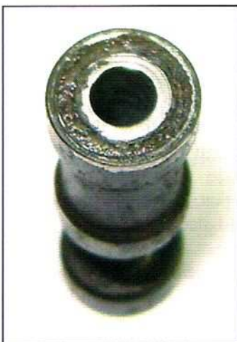
Uszkodzenie elementu amortyzującego na tłoczku na skutek zanieczyszczeń.
